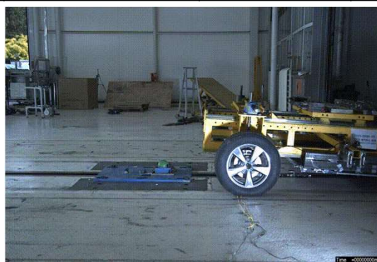
台車底面擦過試験
