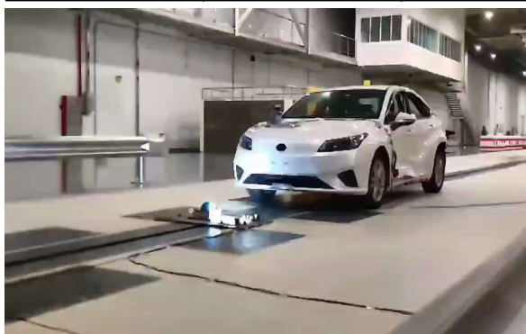
車両底面擦過試験
